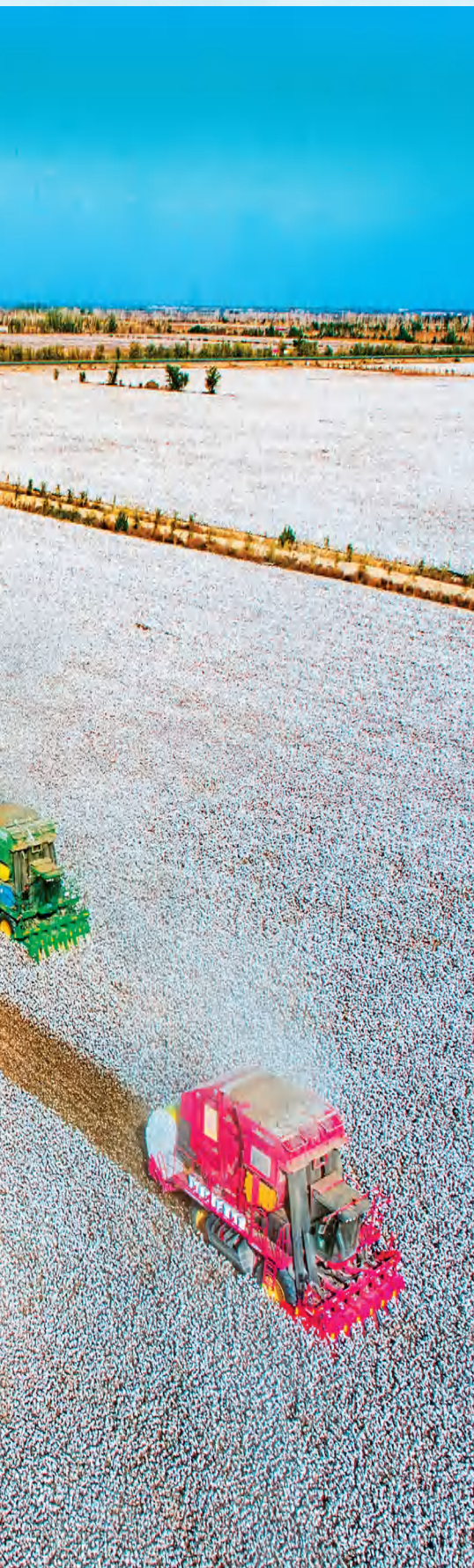
直基地,自走式打包采棉机在棉田里作业。
